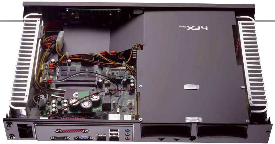
Die Festplatten sind schwingungsbedämpft verbaut, die Kühlung erfolgt auf passivem Weg
